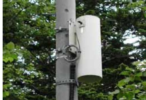
空振計(噴火による空気の振動をとらえる装置)
