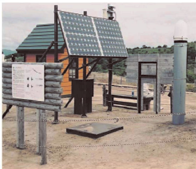
GPS観測装置（左）と電源のソーラーパネル（右）
